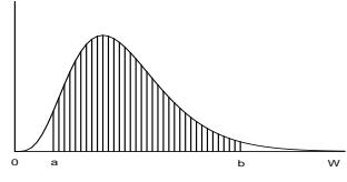
Exemplo 7.2a: Para o tempo de reparação de uma máquina  $X \sim N(\mu, \sigma^2)$ , estime a variância de  $X$  com um grau de confiança de 95%. Recorde-se que  $\bar{x} = 84.6$ ,  $s^2 = 3.933$  e  $n = 10$ .
