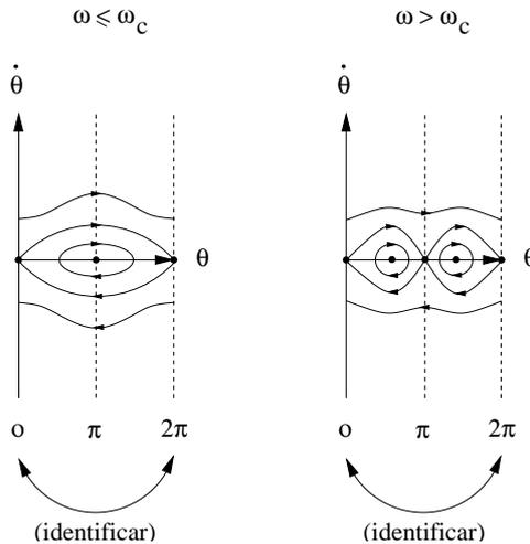
Fisicamente, quando a velocidade de rotação é baixa ( $\omega \leq \omega_c$ ) o sistema comporta-se como um pêndulo; quando a velocidade de rotação é suficientemente elevada ( $\omega > \omega_c$ ) a força centrífuga torna a posição de equilíbrio  $\theta = 0$  instável e faz surgir duas novas posições de equilíbrio estáveis.
